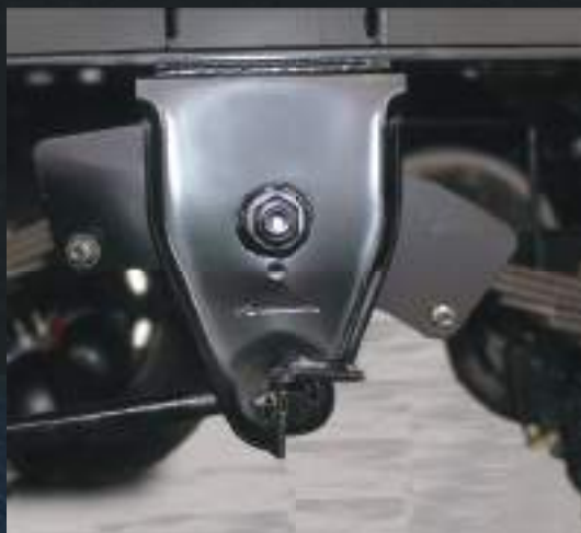
Balancim auto-lub. Não necessita de lubrificação.
