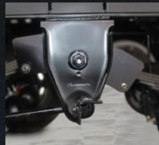
Balancim auto-lub. Não necessita de lubrificação.
