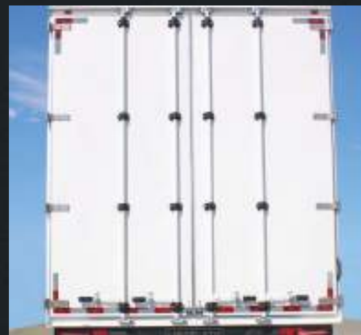
Quadro da caixa de carga reforçado.
