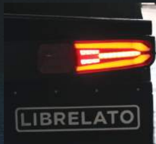
Lanterna traseira com design inspirado na linha automotiva e com indicação de direção sequencial.
