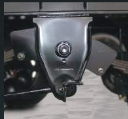
Balancim auto-lub. Não necessita de lubrificação
