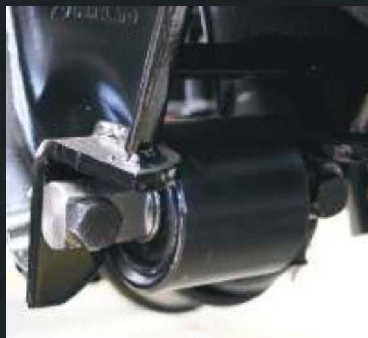
Buchas moleculares do braço tensor. Não desalinha.
