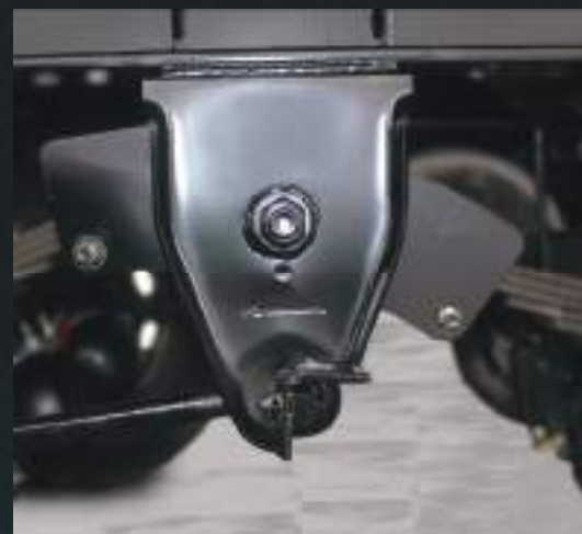
Balancim auto-lub. Não necessita de lubrificação.
