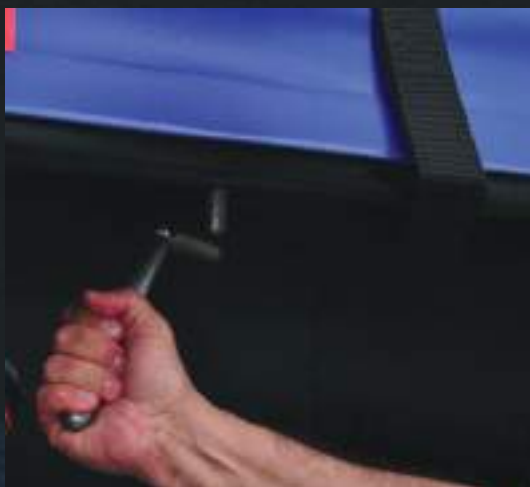
Com central lock, tensionamento da lona em uma única operação.
