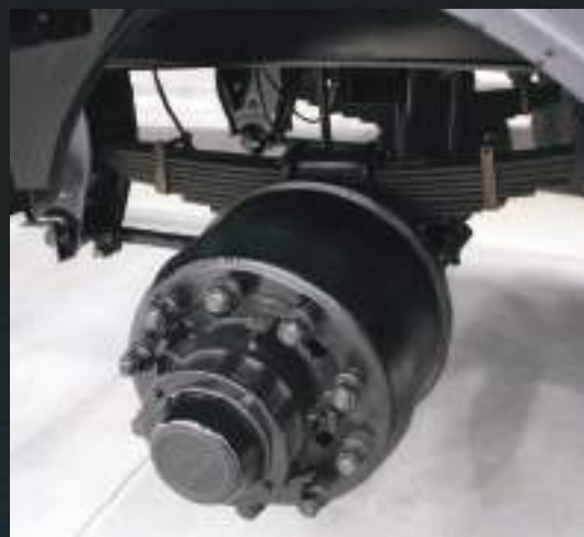
Eixos com cubo outboard e dois rolamentos grandes. Manutenção dos freios sem retirar o cubo do eixo.
